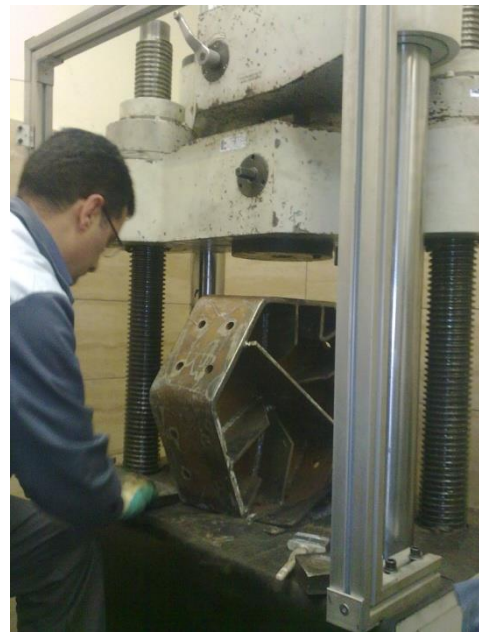
شکل ۱۲- آماده‌سازی یک پیونده شش- پر برای آزمایش یک جهته C0
